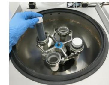
電極含浸電解液を遠心分離機を使用して抽出
